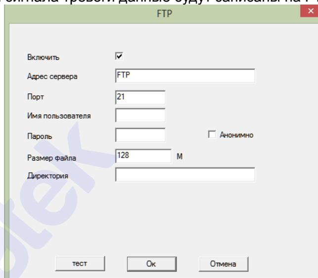
【Адрес сервера】 IP адрес FTP сервера.
