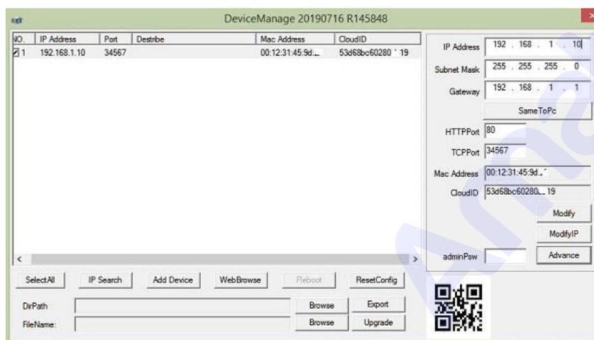
2. Нажмите «IP Search» для поиска. Программа отобразит список подключенных IP устройств. Выберите вашу IP камеру в списке.
