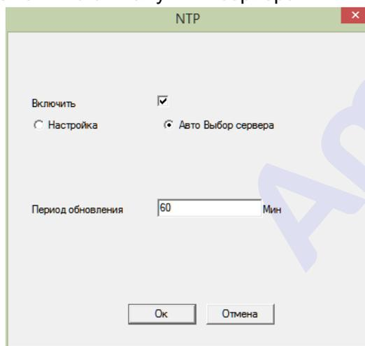
**Примечание:** NTP сервер должен быть установлен на локальном сервере или ПК.
