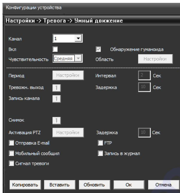
【Канал】 Номер канала (для IP камеры только 1-й канал).
